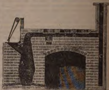
Фиг. 1. Шахтная печь для обжиганія костей.
